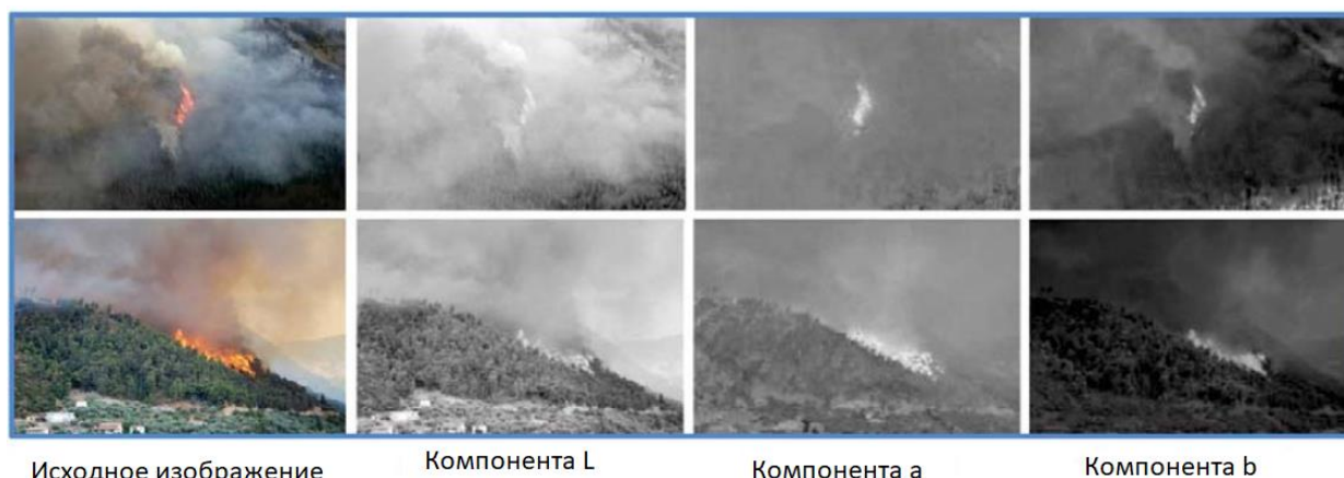
Рис. 5. Отображение пламени в каждой компоненте Lab модели Fig. 5. Displaying the flame in each component of the Lab model
