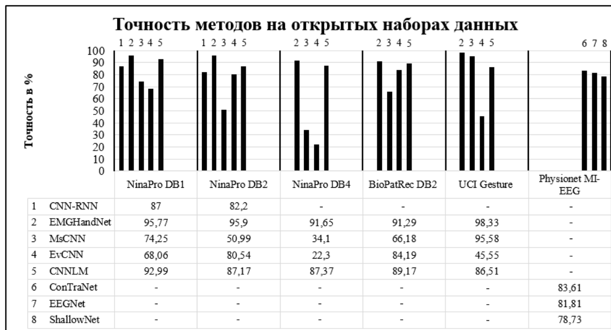
Рис. 2. Средняя точность методов на открытых наборах данных ЭМГ-сигналов Fig. 2. Average accuracy of the methods on open datasets of EMG signals
