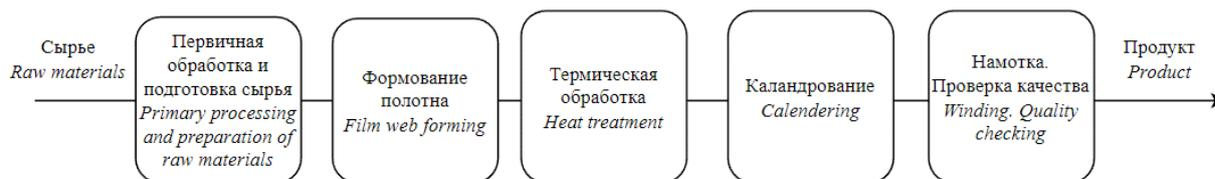
Рис. 2. Упрощенная схема процесса производства ТКМ
