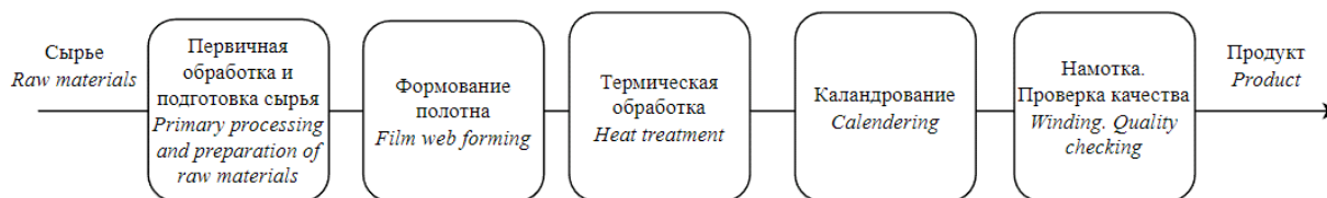
Рис. 2. Упрощенная схема процесса производства ТКМ
