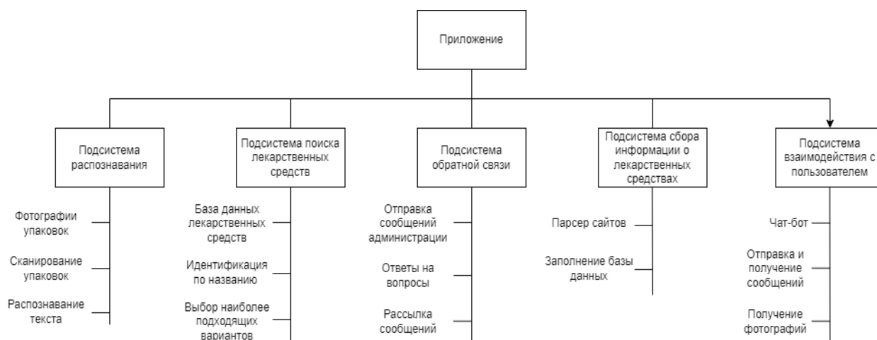
Рис. 1. Структурная схема приложения Fig. 1. Application structure diagram
