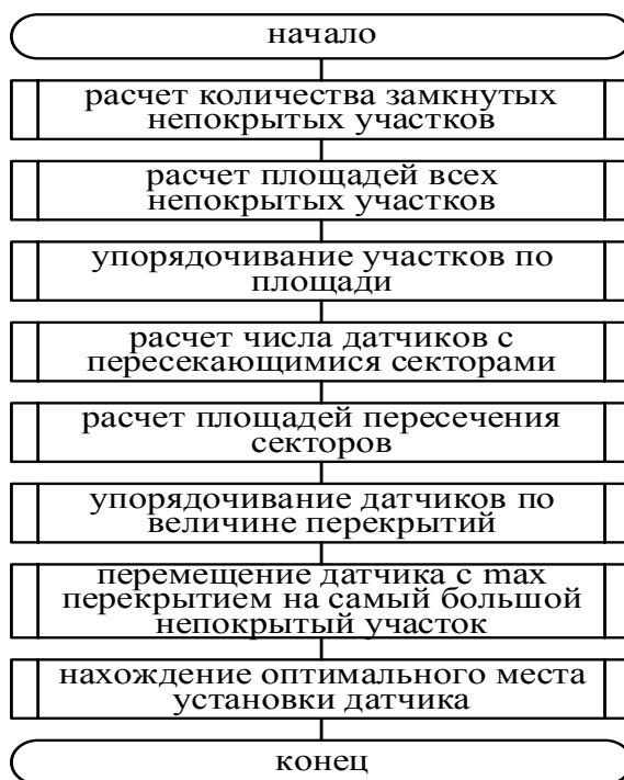
Рис. 3. Алгоритм генерации нового размещения высокоскоростных датчиков на местности Fig. 3. Algorithm for generating a new placement of high-payload sensors on the ground
