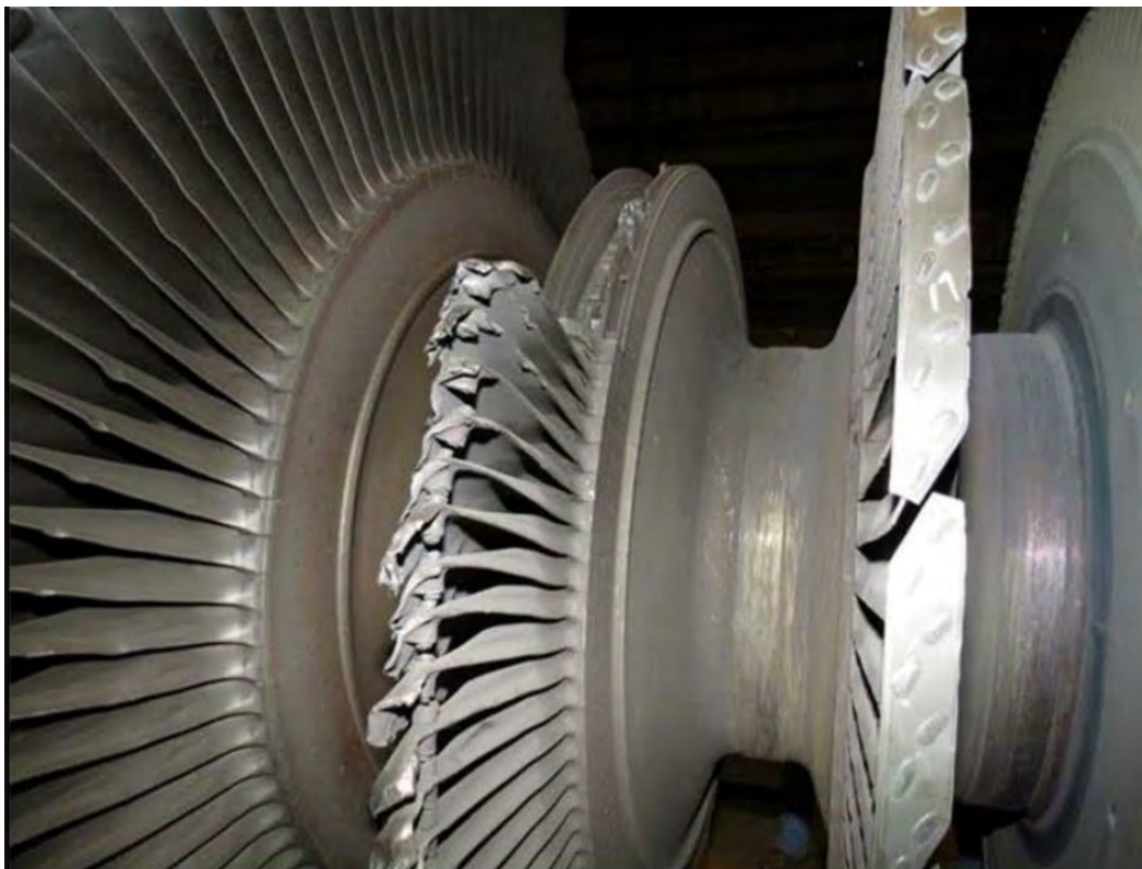
Рис. 4. Иллюстративное фото значительных разрушений при отказе турбины авиадвигателя
