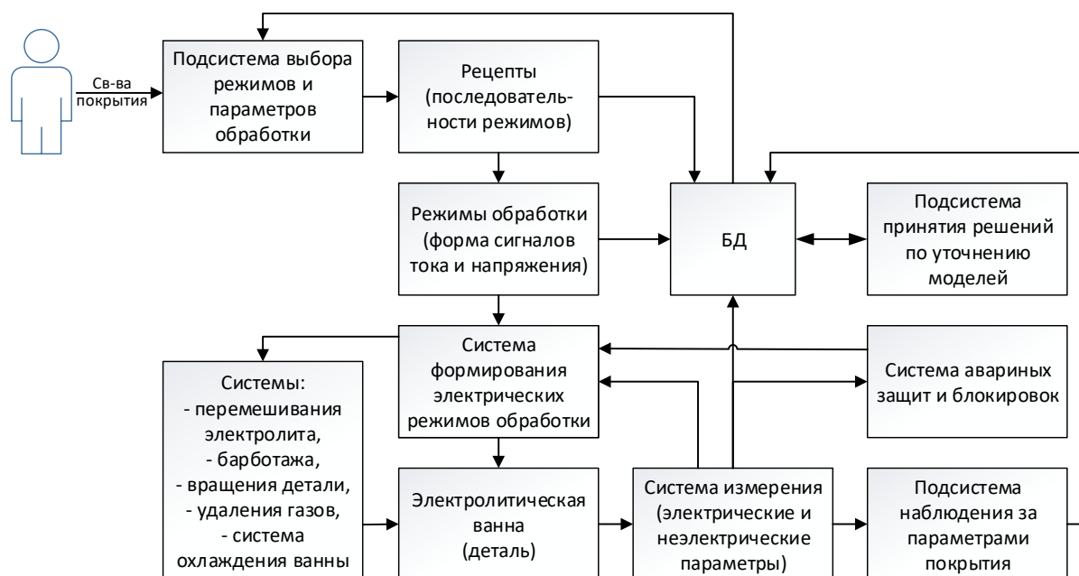
Рис. 1. Функциональная схема установки МДО для научных исследований Fig. 1. Functional diagram of the MAO facility for scientific research
