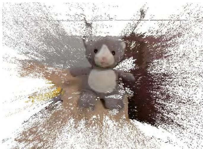
Рис. 10. Построение объемной модели на основе карты глубины
