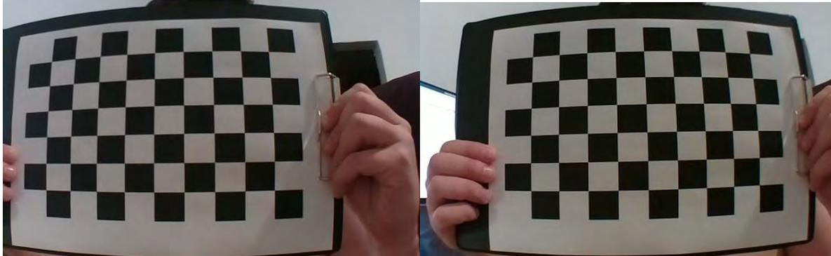
Рис. 6. Тестовый пример пары снимков для получения данных о глубине, с использованием калибровочной доски, для калибровки системы
