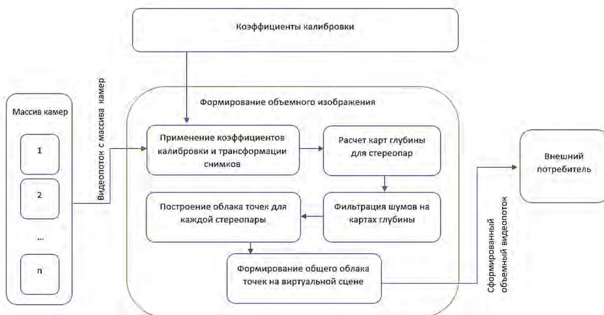
Рис. 1. Структурная модель построения объемного панорамного изображения
