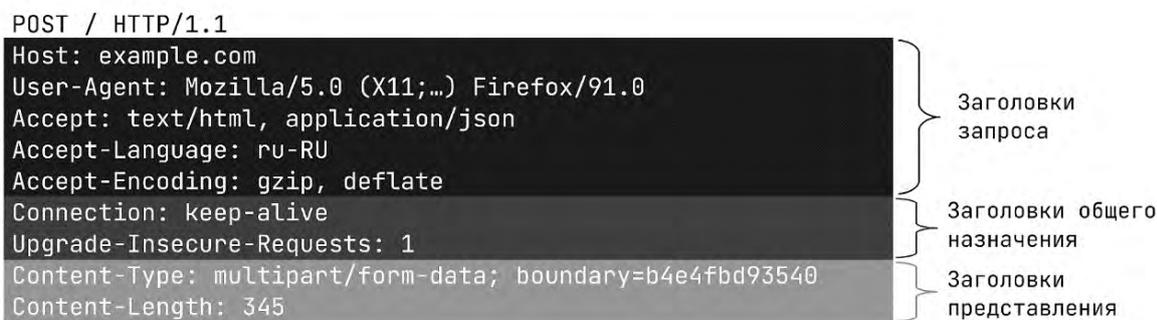
Рис. 1. Структура HTTP-заголовка
