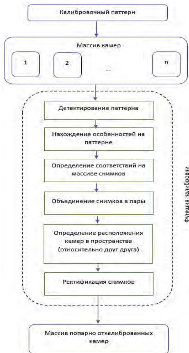
Рис. 5. Модель процесса калибровки многокамерных систем
