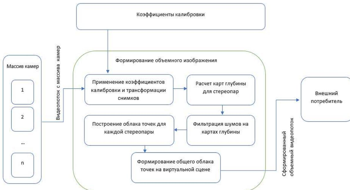
Рис. 1. Пассивный метод построения объемного изображения
