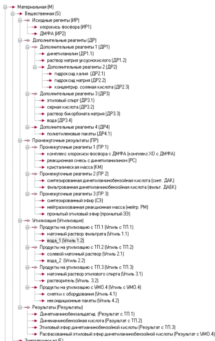
Рис. 7. Связи УФО-модели производства этилового эфира диметиламинобензойной кислоты Fig. 7. Connections of the UFO model for the production of dimethylaminobenzoic acid ethyl ester
