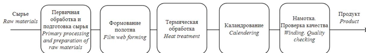
Рис. 2. Упрощенная схема процесса производства ТКМ
