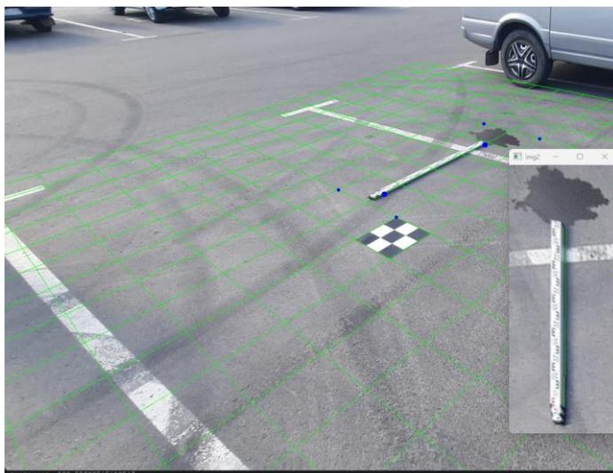
Рис. 13. Результат измерения расстояния на 2D проекции
