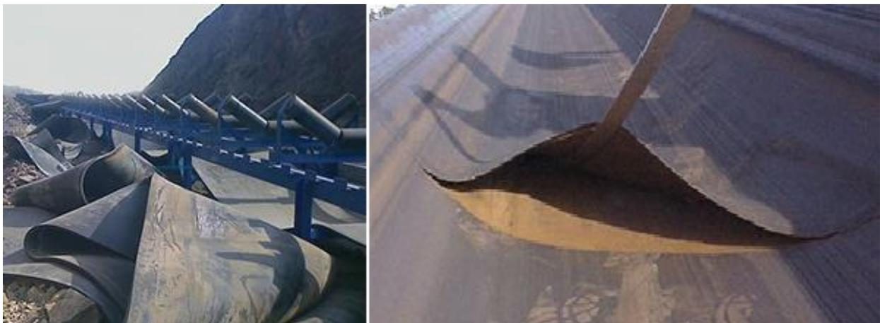
Рис. 1. Выход из строя транспортной системы в результате повреждения ленты конвейера
