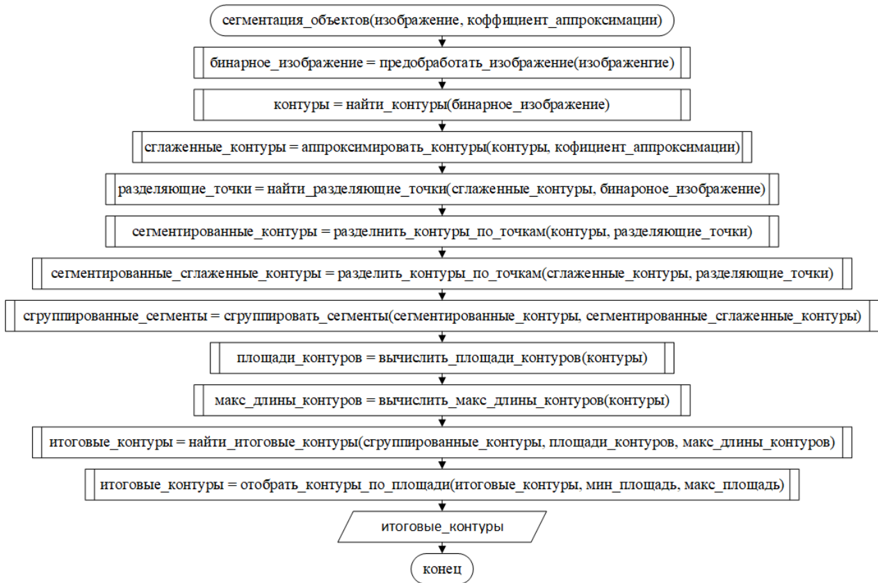
Рис. 3. Блок-схема сегментации перекрывающихся объектов на изображении Fig. 3. Block diagram of segmentation of overlapping objects in the image
