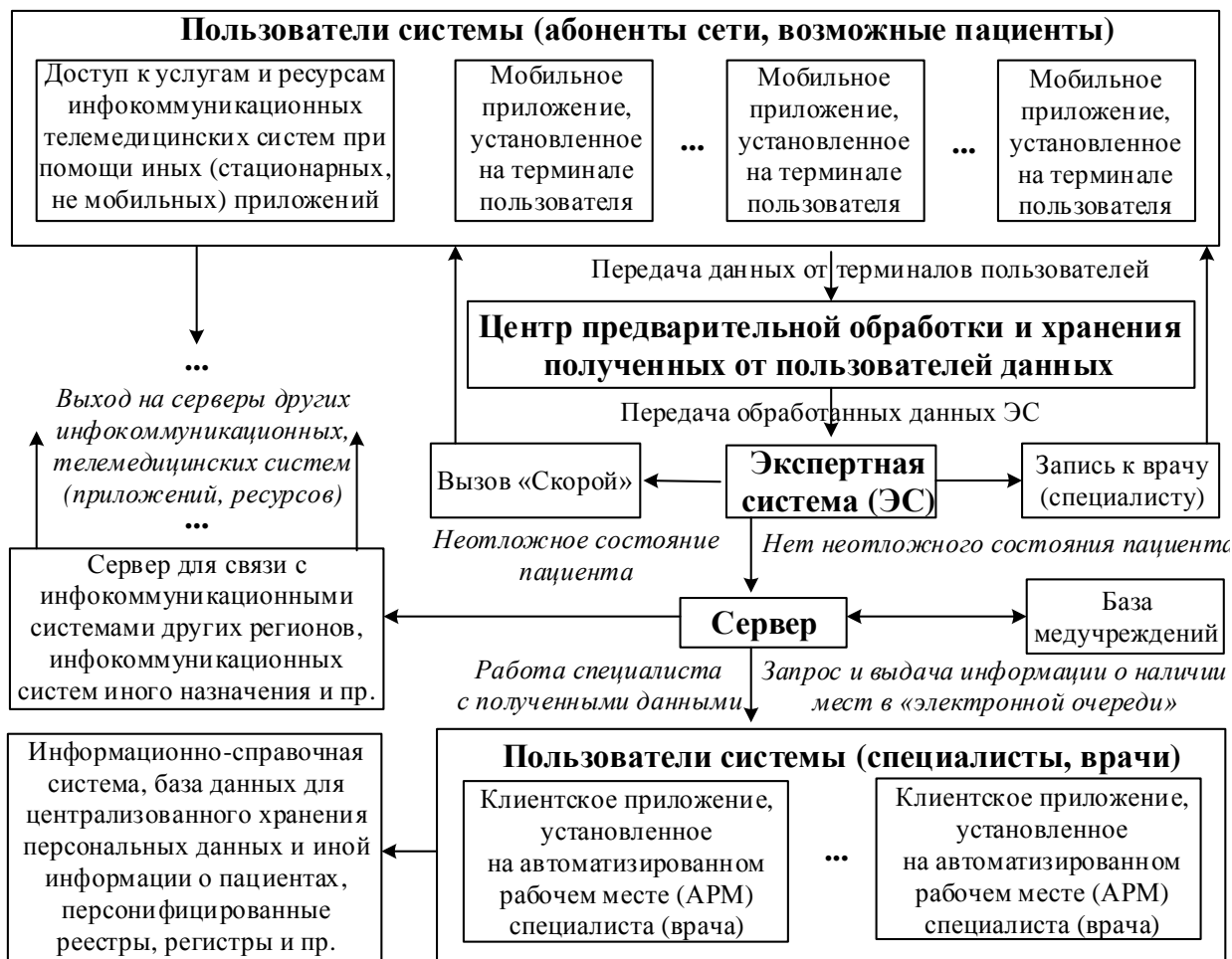
Рис. 2. Вариант реализации типовой инфокоммуникационной системы, предназначенной для сбора и анализа данных о состоянии здоровья населения
